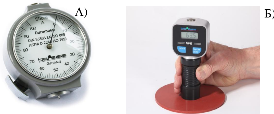
Рисунок 1 - Внешний вид твердомеров HP-A, HP-AS - А), HPE II Shore A - Б)
