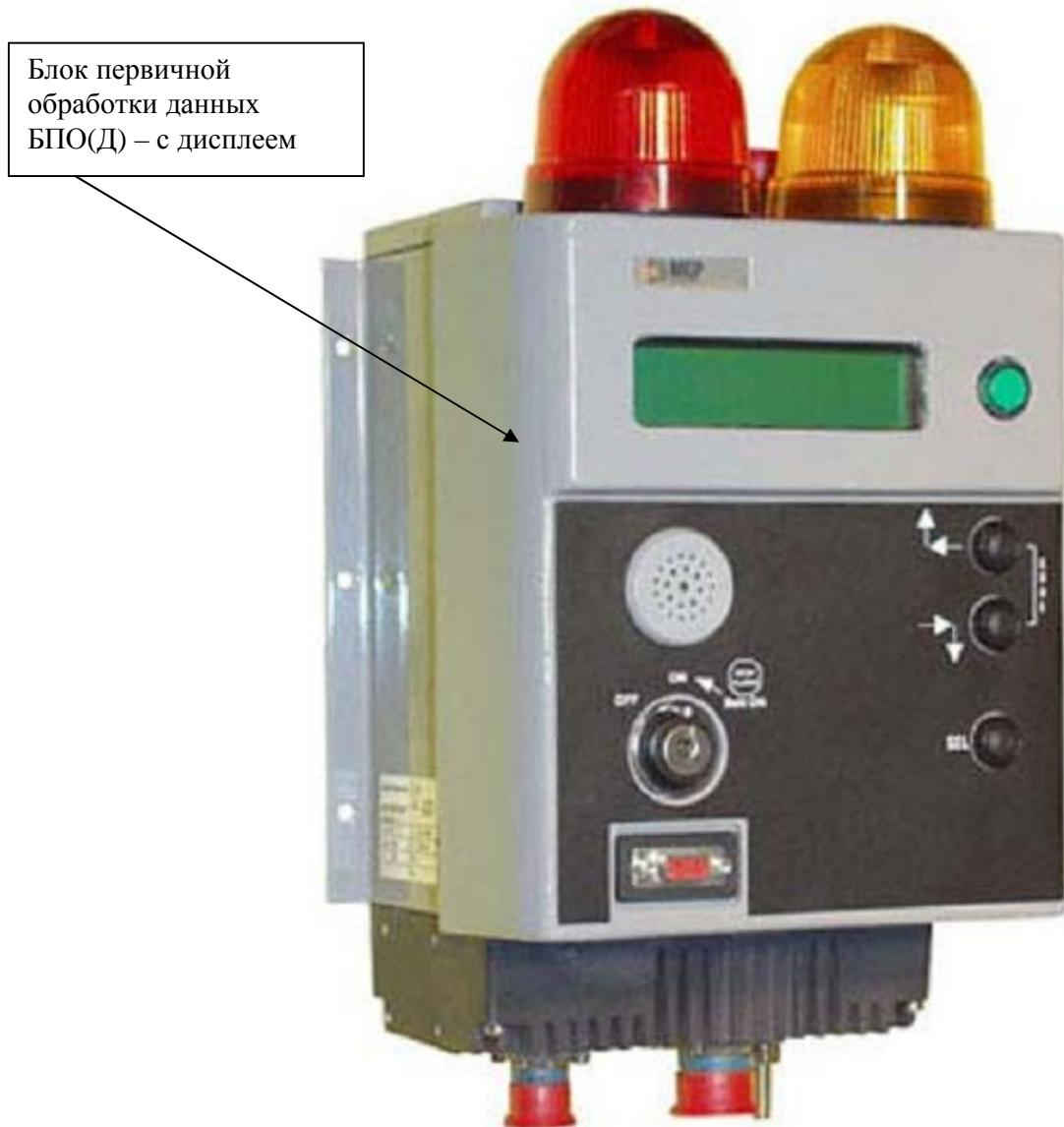
Рисунок 2 – Внешний вид УДЖГ-211 (Блок первичной обработки данных БПО(Д) - с дисплеем).
