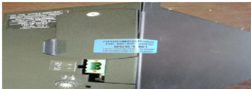
Рисунок 2 — В комплект "Хранитель-1" разъем и корпус блока обработки информации (БОИ) пломбируются пломбой и пломбонаклейкой.
