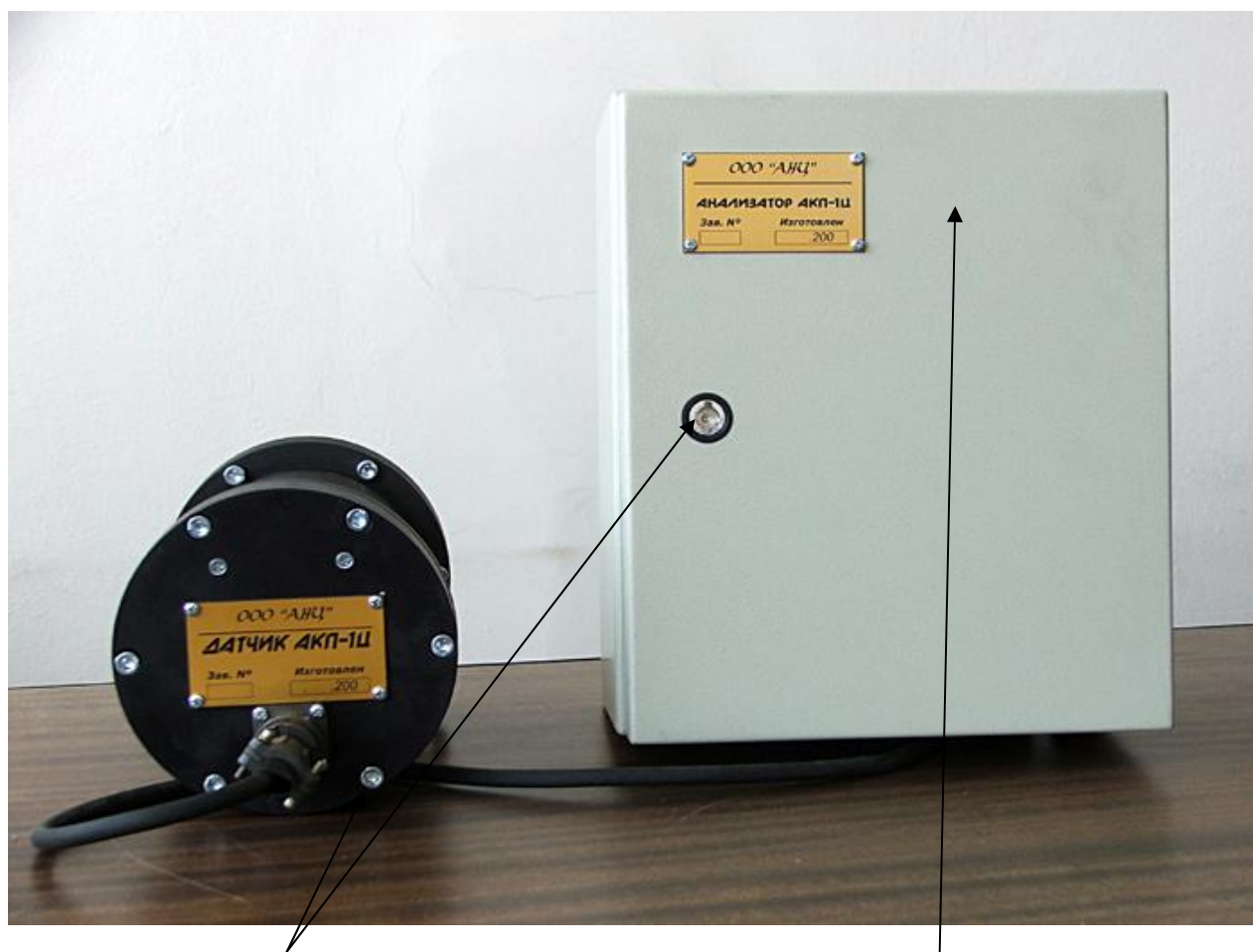
Рисунок 1 – Общий вид, схема пломбировки анализатора АКП-1Ц, обозначение места нанесения знака поверки в виде наклейки
