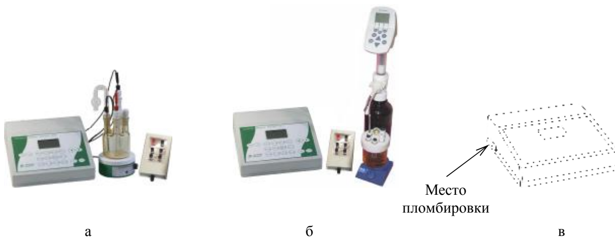
Рисунок 1 – Внешний вид кулонометрического (а), волюмометрического (б) титратора и место пломбировки ИП титратора от несанкционированного доступа (в).
