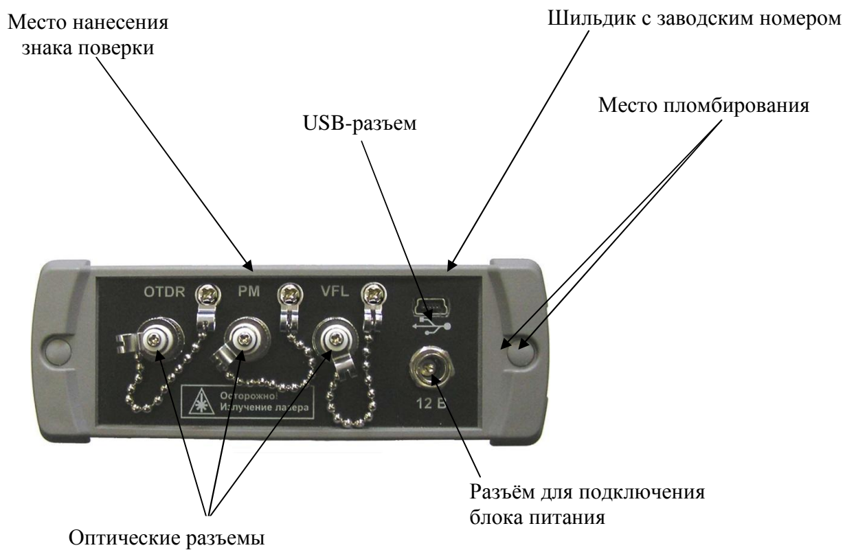
Рисунок 2 - Схема пломбирования и маркировки рефлектометров оптических VISA
