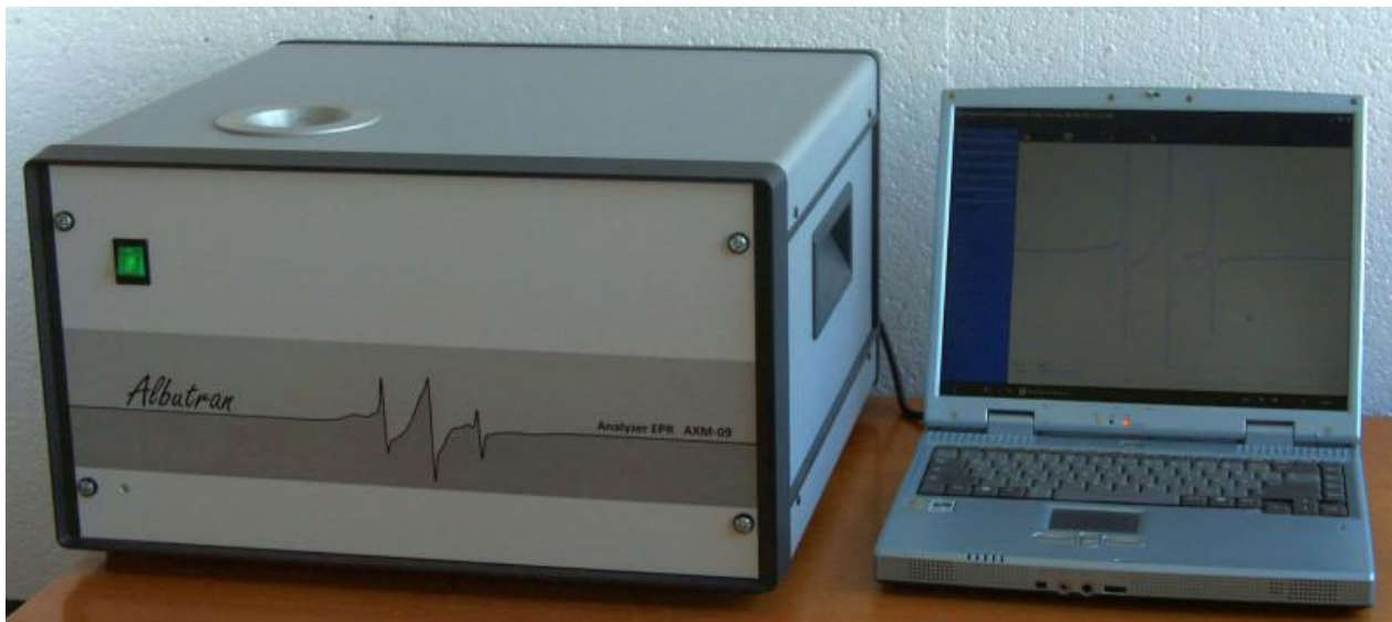
Рисунок 1- Анализатор лабораторный электронного парамагнитного резонанса «ЭПР АХМ-09» - общий вид
