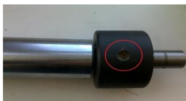
Рисунок 4 - Установка пломбы на измерительном блоке
