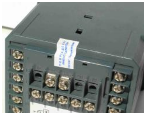
Рисунок 2 – Схема и внешний вид пломбировки регулятора от несанкционированного доступа.
