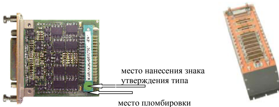
Рисунок 1 - Внешний вид модуля KAD/ADC/008 и модуля KAD/ADC/008 установленного в шасси KAM/CHS/13U
