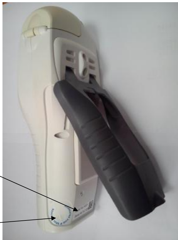
Рисунок 2 – Места нанесения маркировки и пломбирования
