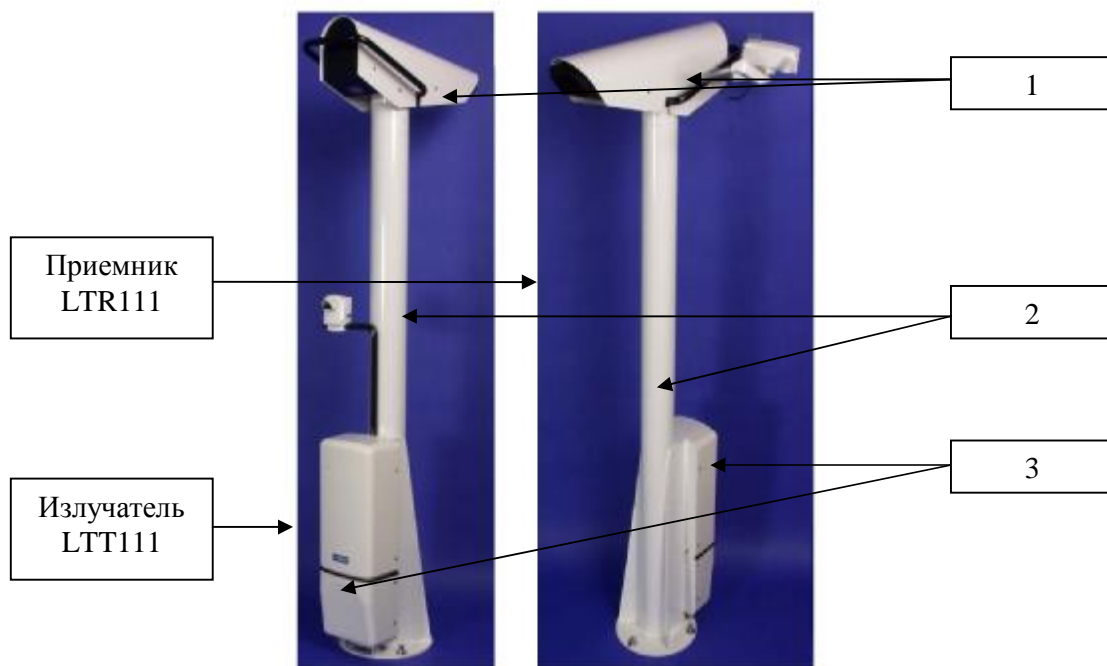
Рисунок 1. Трансиссометры LT31 1 - Измерительный блок, 2-мачта, 3-интерфейсный блок
