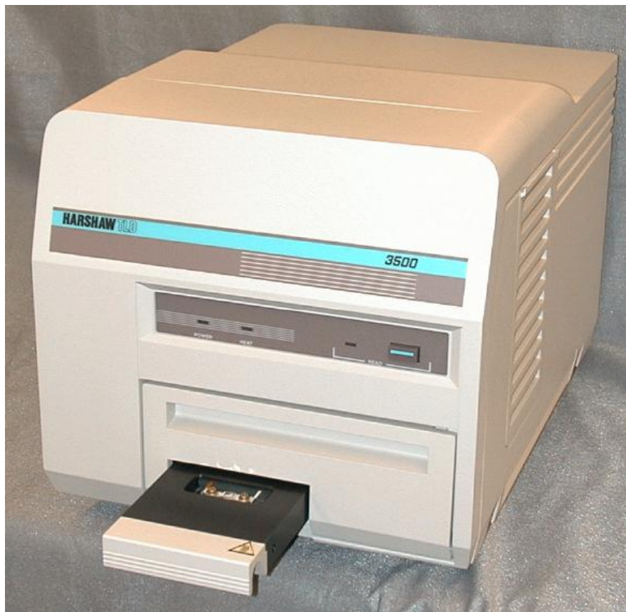
Рисунок 1. Считывающее устройство системы ТЛД Harshaw модели 3500
