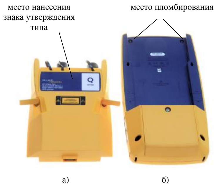
Рисунок 2 – Рефлектометр оптический OptiFiber Pro (вид сзади) а) сменный оптический модуль; б) базовый блок.
