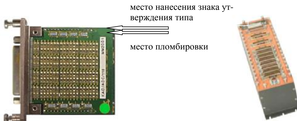
Рисунок 1 - Внешний вид модуля KAD/ADC/118 и модуля KAD/ADC/118 установленного в блок базовый KAM/CHS/13U
