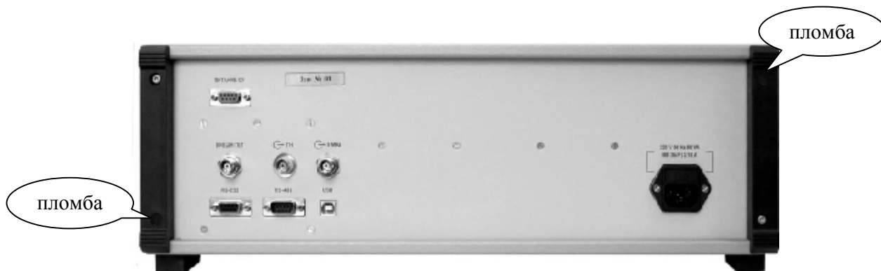
Рисунок 2 - Пломбирование аппаратного блока установки эталонной для поверки мер ослабления и магазинов затухания ЭО-01
