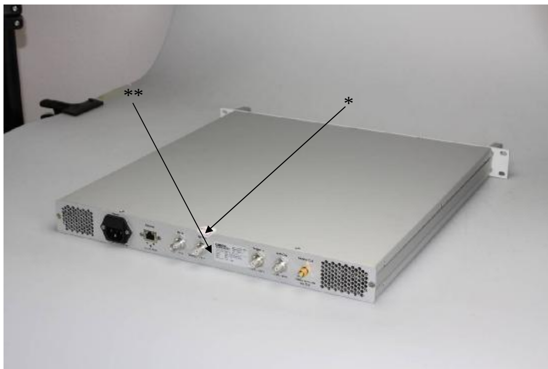
Рисунок 4 – Места пломбировки от несанкционированного доступа и нанесения знака об утверждении типа генератора сигналов из состава имитатора NavX-NCS Essential
