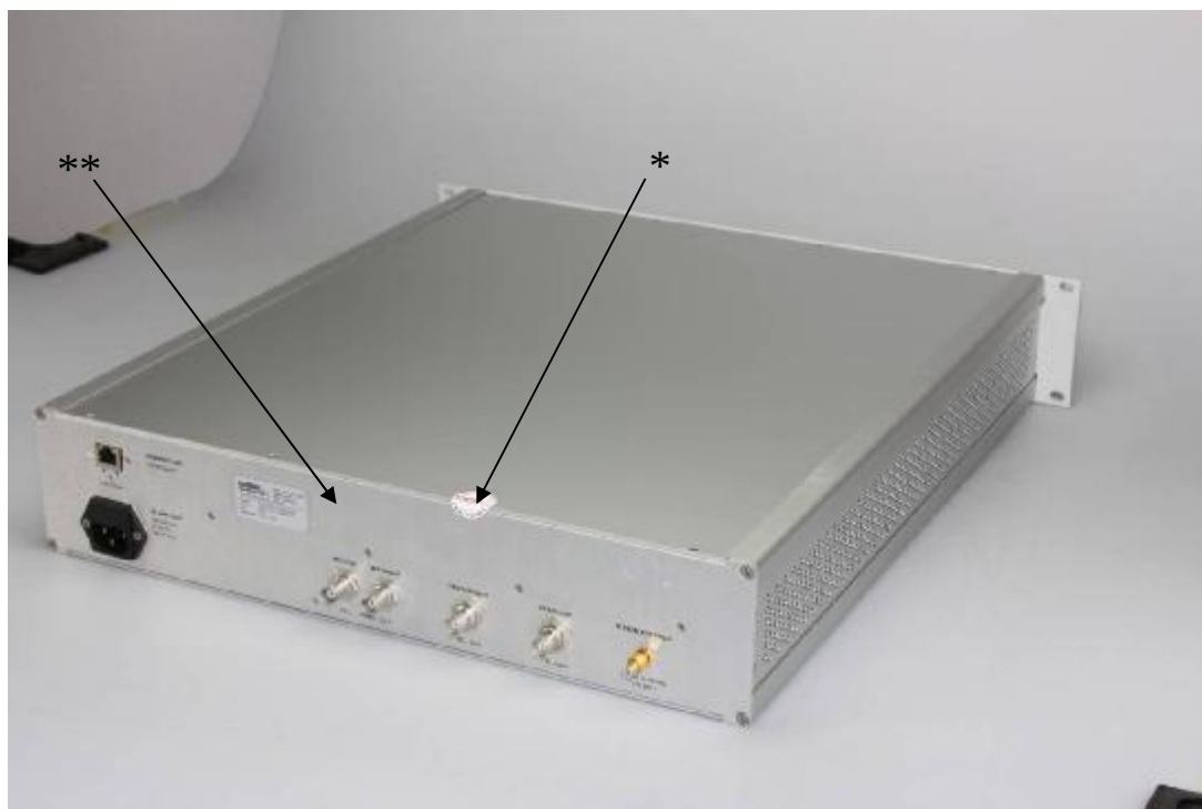
Рисунок 2 – Места пломбировки от несанкционированного доступа и нанесения знака об утверждении типа генератора сигналов из состава имитатора NavX-NCS Professional
