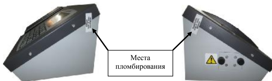
Рисунок 3 - Места пломбирования камеры спектроколориметров Lovibond серии PFXi моделей 880, 950 и 995.
