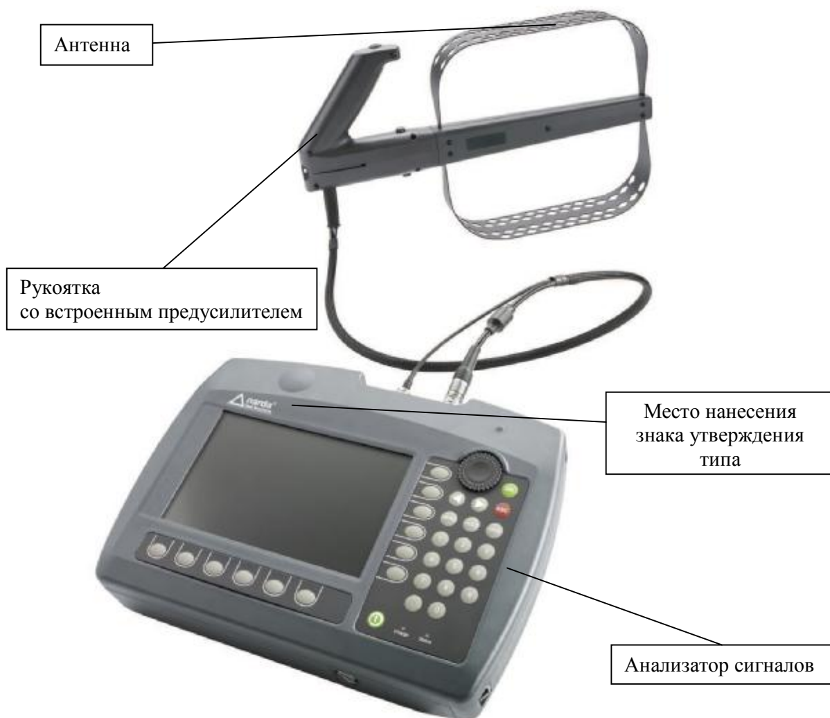
Рисунок 1 – Внешний вид измерителя радиопомех пеленгационного IDA-3106
