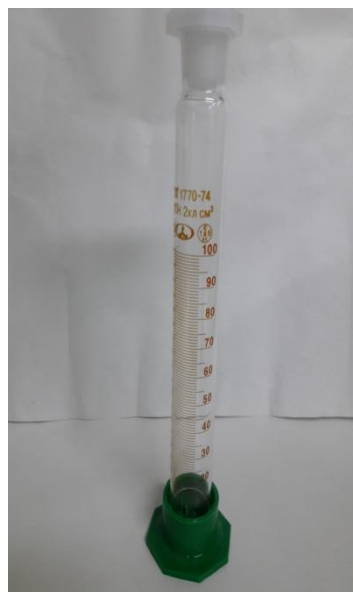
Рисунок 4 - Общий вид цилиндров исполнения 4а
