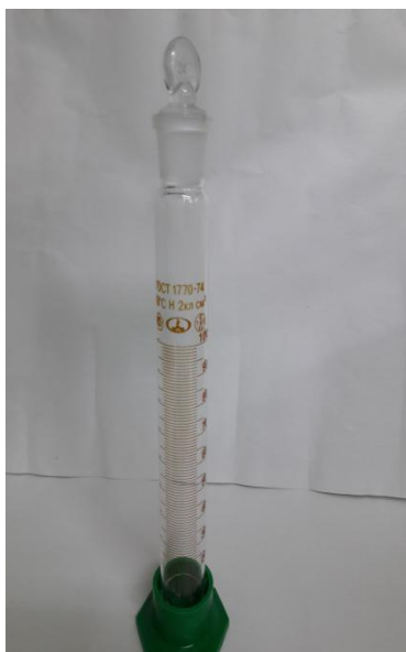
Рисунок 3 - Общий вид цилиндров исполнения 4
