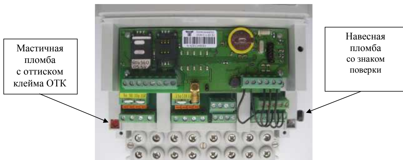
Рисунок 3 - Внешний вид счетчика внутренней установки со снятой крышкой зажимов
