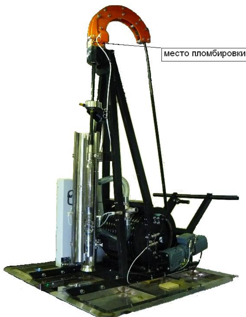
Рисунок 4 - Общий вид УЗ-СИПИ-М и схема пломбировки от несанкционированного доступа
