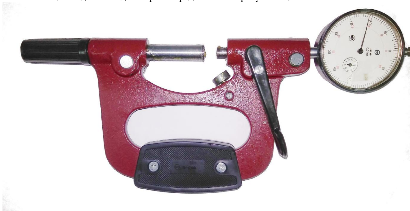
Рисунок 1 - Общий вид скоб индикаторных модификаций СИ 50, СИ 100
