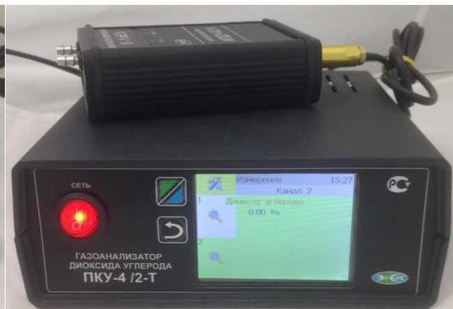
г) исполнение ПКУ-4 /2-Т (двухканальный, на фото показан только один измерительный преобразователь)
