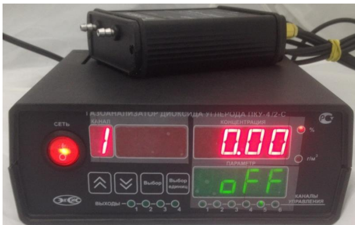
в) исполнение ПКУ-4 /2-С (двухканальный, на фото показан только один измерительный преобразователь)
