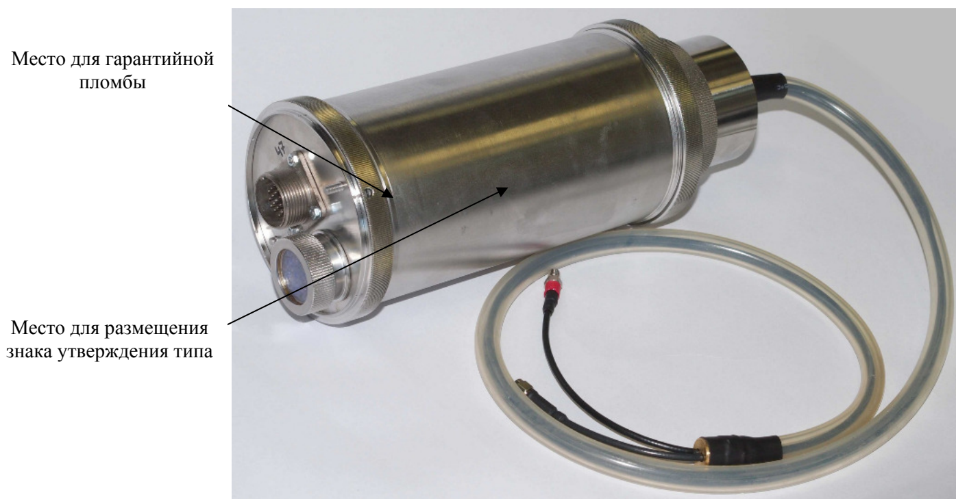
Рисунок 5 - Внешний вид модуля электрометра
