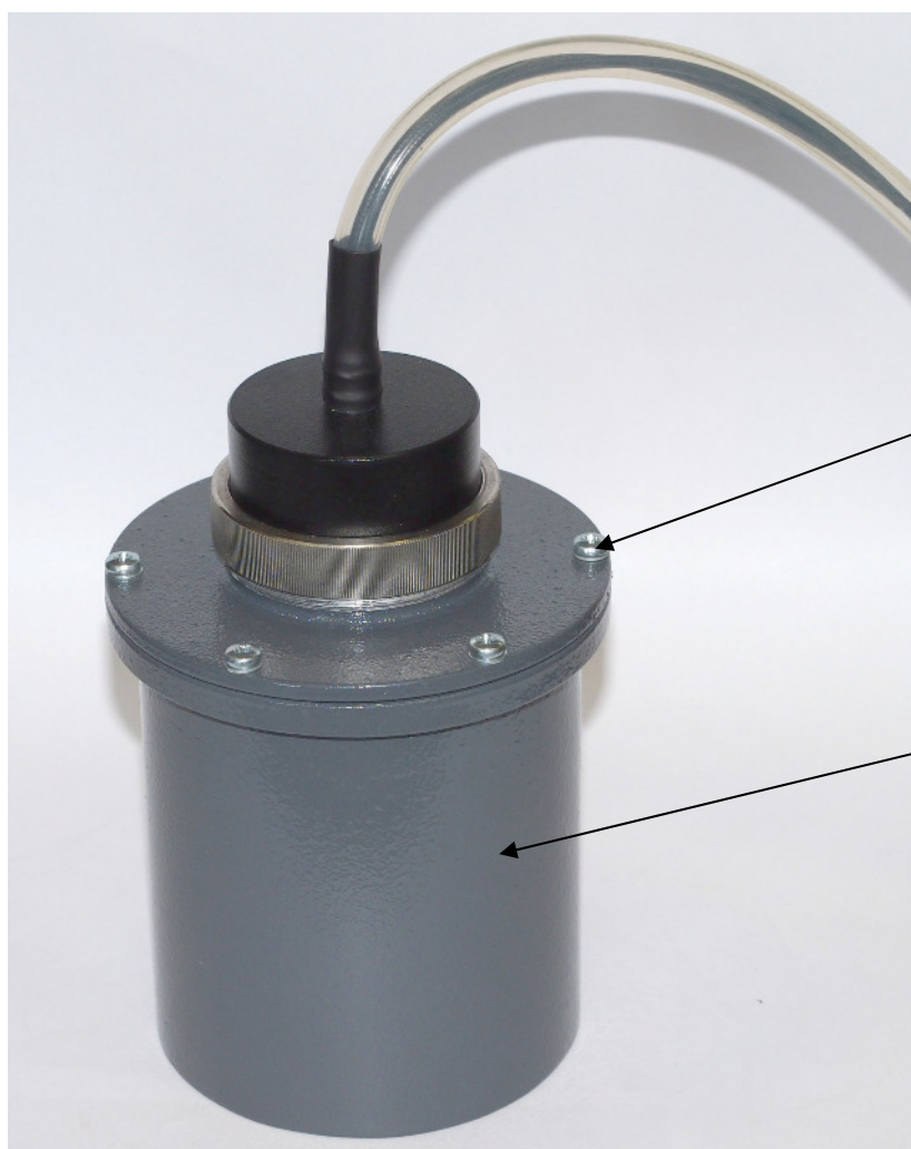
Рисунок 3 - Внешний вид модуля ионизационной камеры МИК-03
