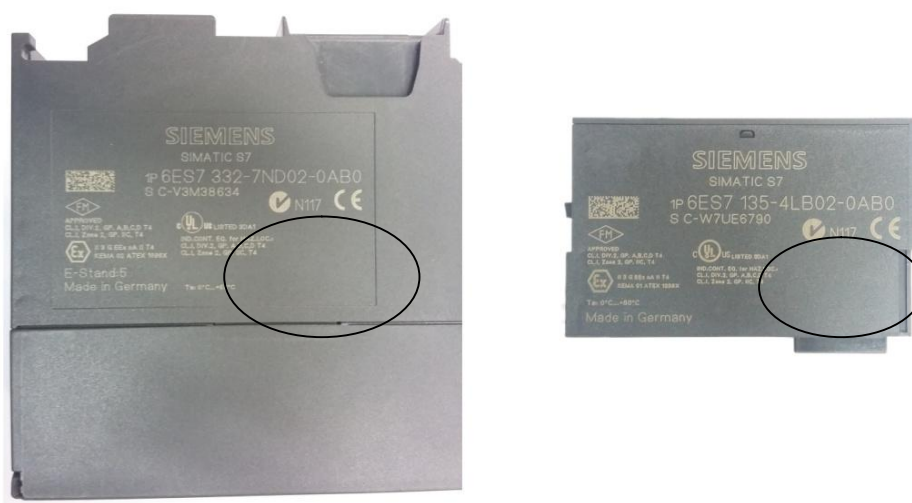
Рисунок 2 - Обозначения мест нанесения знака поверки
