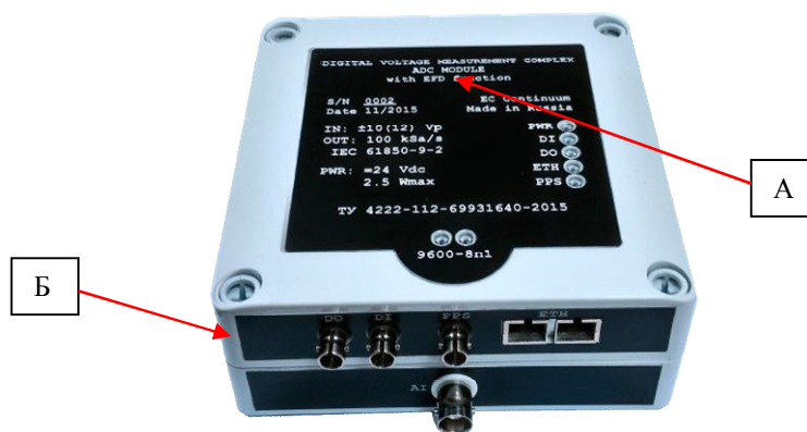
Рисунок 2 - Место пломбировки от несанкционированного доступа (Б) и обозначение места нанесения знака поверки (А)
