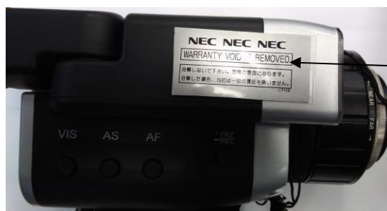
Рисунок 3 - Схема пломбировки от несанкционированного доступа
