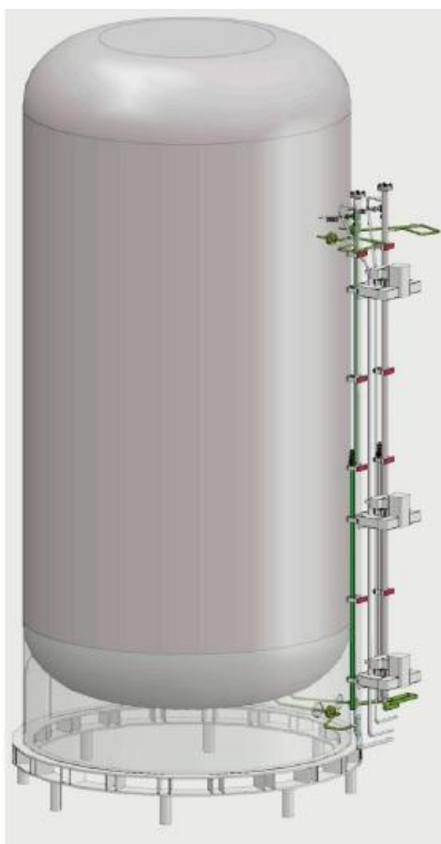
Рисунок 4 - Пример монтажа уровнемера, модификация ALM_D3_LXXXXX
