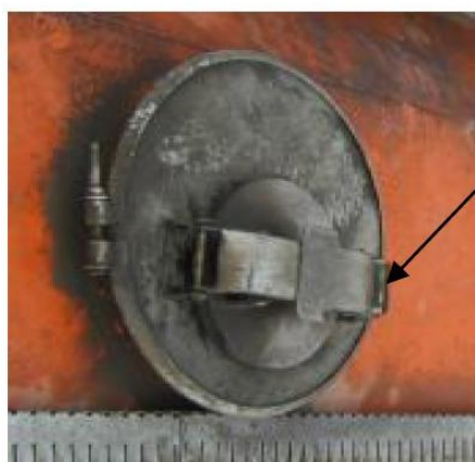
Рисунок 2 - Место пломбировки от несанкционированного доступа
