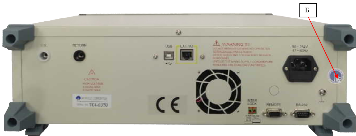
Рисунок 2 - Схема пломбировки от несанкционированного доступа (Б)
