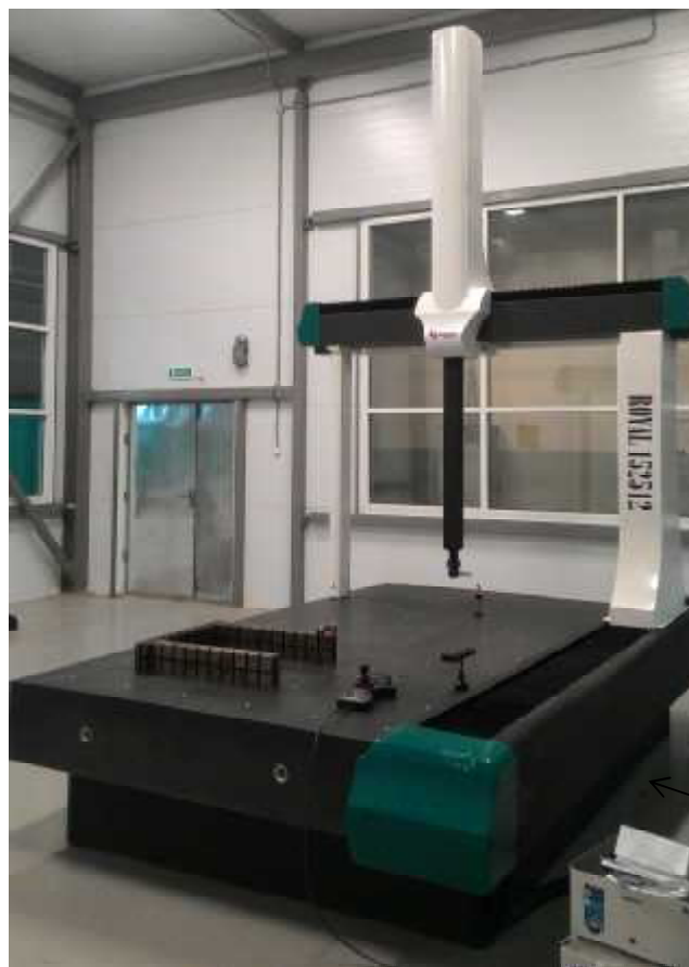
Рисунок 1 - Общий вид машины координатной измерительной ROYAL 152512
