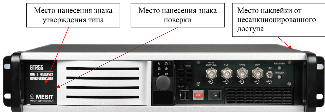
Рисунок 1 - Внешний вид приемно-измерительного устройства из состава аппаратуры и схема пломбировки
