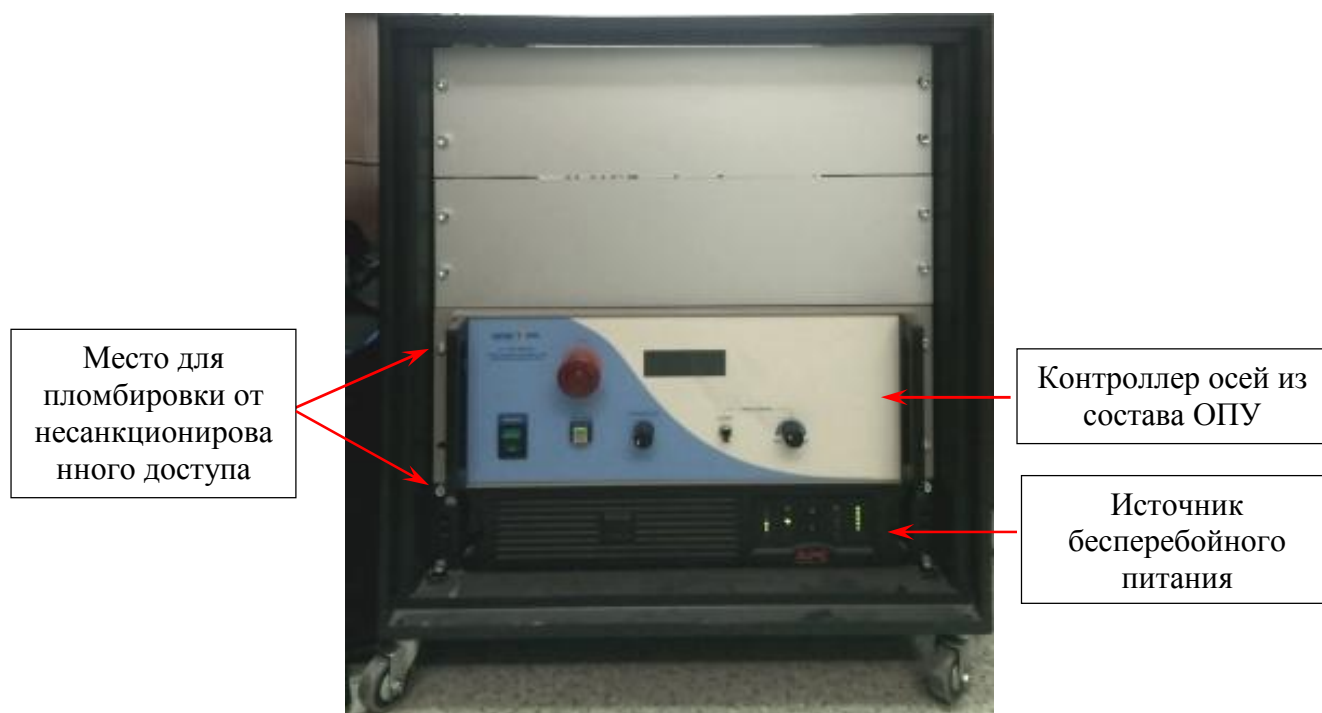
Рисунок 11 - Внешний вид приборной стойки с установленным оборудованием
