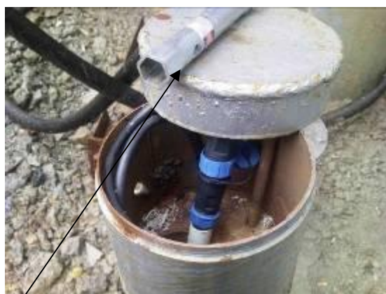
Рисунок 5 - Место пломбировки от несанкционированного доступа крышки скважины и внешний вид термогирлянды, установленной в скважине, с подключением к общей шине
