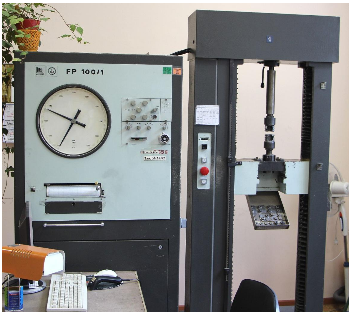
Рисунок 1 - Общий вид машины испытательной FP 100/1
