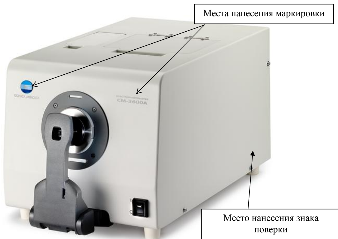
Рисунок 1 - Общий вид спектроколориметра CM-3600A с обозначением мест нанесения маркировки и знака поверки
