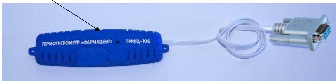
Рисунок 3 - Внешний вид термогигрометров с указанием места нанесения знака поверки
