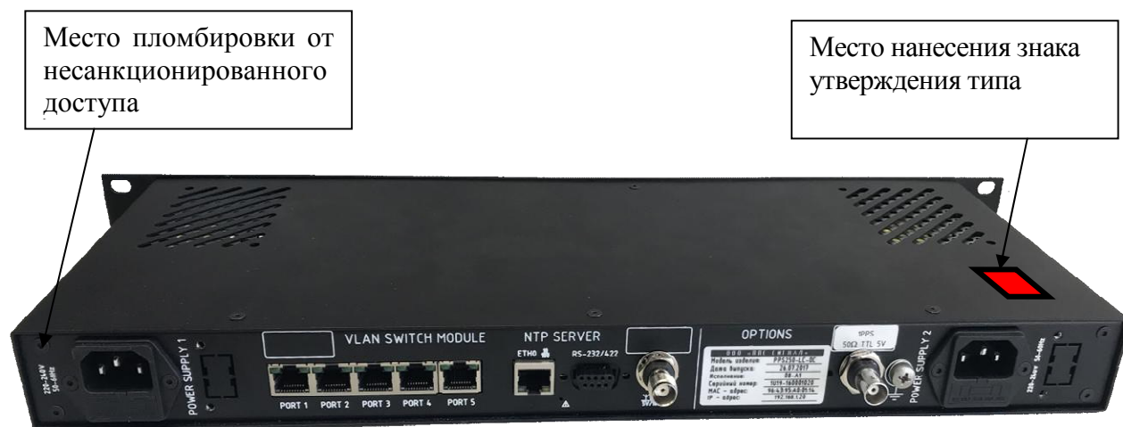
Рисунок 2 - Общий вид и схема пломбировки от несанкционированного доступа CTB PPS200/1U19GNSS-NTP и PPS250
