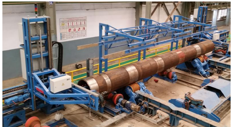
б - Измерительная система фаски и длины труб
