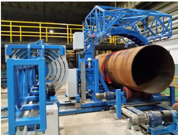
а - Измерительная система контроля диаметра труб
