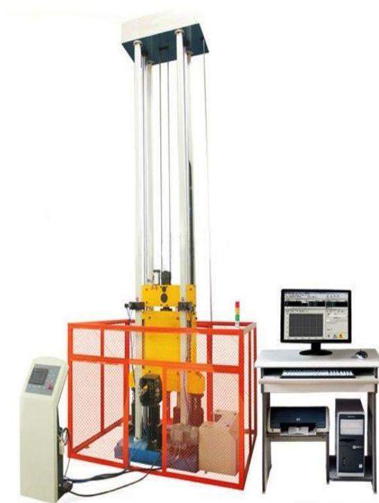
Рисунок 2 - Общий вид копров вертикальных КВ с ручным управлением и выводом данных на ПК
