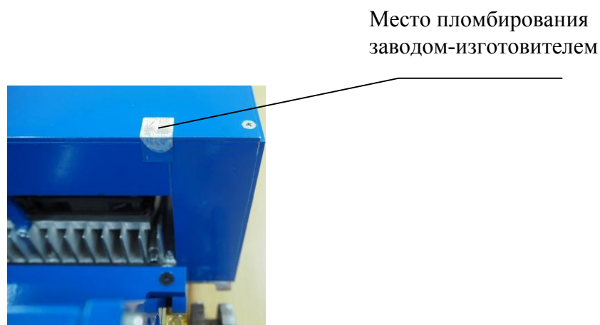
Рисунок 2 - Схема пломбировки от несанкционированного доступа
