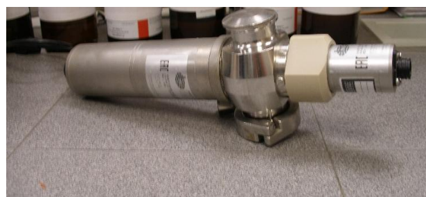
Рисунок 3 - Общий вид датчика MOD-A45, MOD-A-46 с ячейкой d=20 мм
