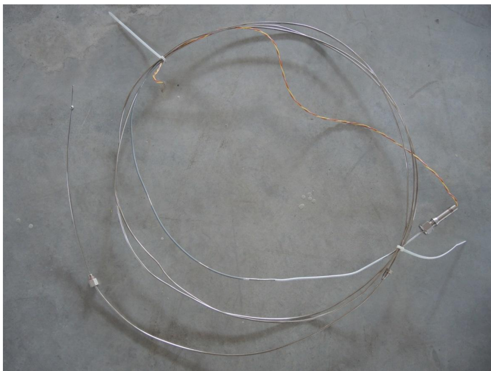
Рисунок 1 - Общий вид преобразователей термоэлектрических модели 397A7666 исполнений P006, P008, P009, P011
