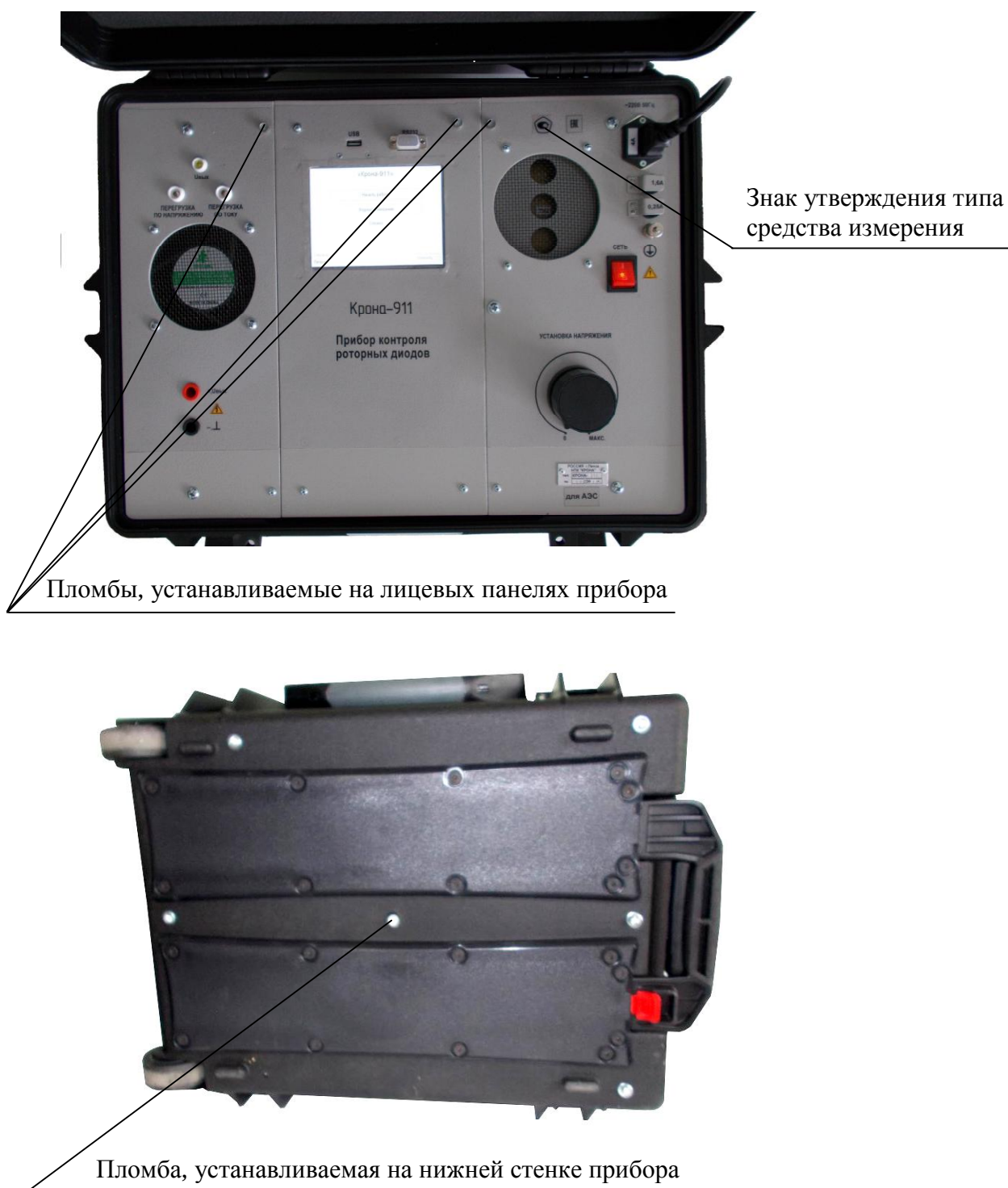
Рисунок 1 - Общий вид прибора контроля роторных диодов «Крона-911», место нанесения на него знака утверждения типа средства измерений и схема пломбирования от несанкционированного доступа
