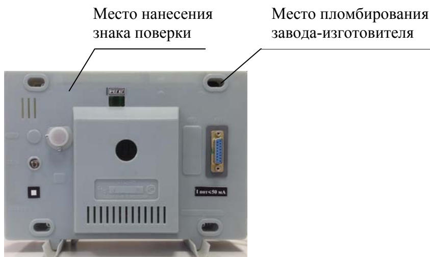
Рисунок 2 - Схема пломбировки от несанкционированного доступа
