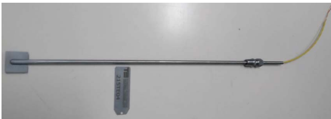
Рисунок 1 - Общий вид ТП исполнения 215TE04
