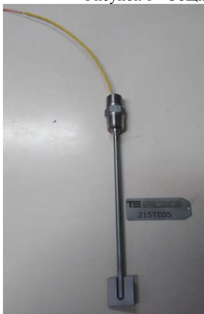
Рисунок 2 - Общий вид ТП исполнения 215TE05
