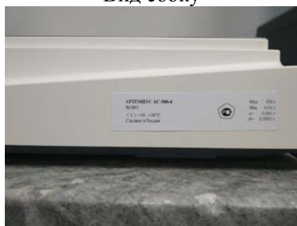
Рисунок 2 - Схема пломбировки и маркировки весов
