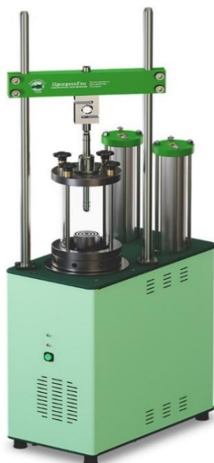
Рисунок 11 - Общий вид устройства для исследования образцов грунта ЛИГА модификации КЛ1С с применением камеры трёхосного сжатия с двумя волюмометрами
