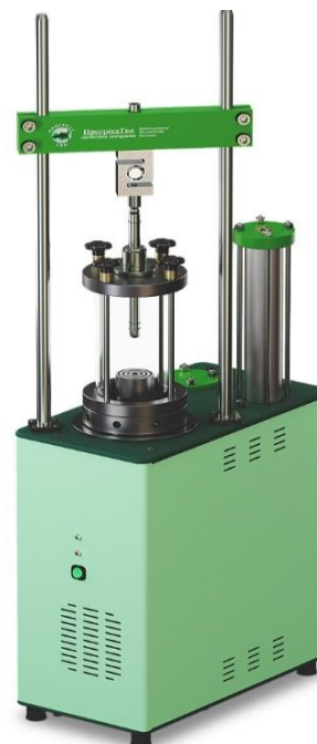
Рисунок 8 - Общий вид устройства для исследования образцов грунта ЛИГА модификации КЛ1С с применением камеры трёхосного сжатия с одним волюмометром
