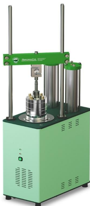
Рисунок 7 - Общий вид устройства для исследования образцов грунта ЛИГА модификации КЛ1 с применением компрессионного одометра с двумя волюмометрами
