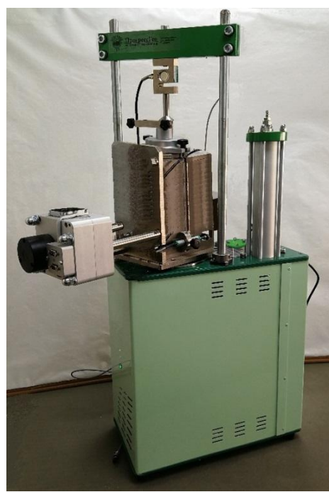
Рисунок 10 - Общий вид устройства для исследования образцов грунта ЛИГА модификации КЛ1С с применением срезовой/сдвиговой каретки с одним волюмометром
