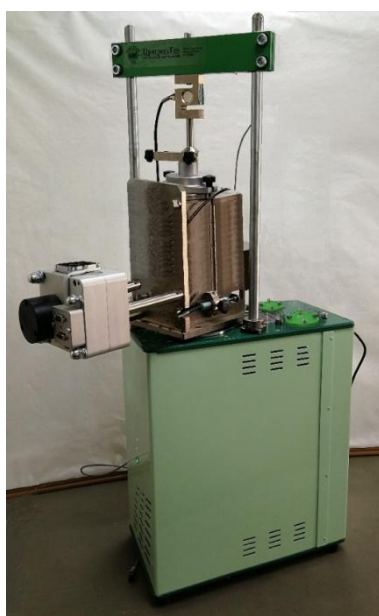
Рисунок 3 - Общий вид устройства для исследования образцов грунта ЛИГА модификации КЛЮС с применением срезовой/сдвиговой каретки
