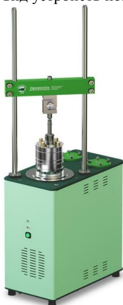
Рисунок 1 - Общий вид устройства для исследования образцов грунта ЛИГА модификации КЛЮ с применением компрессионного одометра
