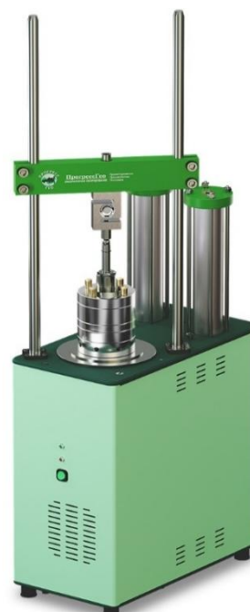
Рисунок 12 - Общий вид устройства для исследования образцов грунта ЛИГА модификации КЛ1С с применением компрессионного одометра с двумя волюмометрами
