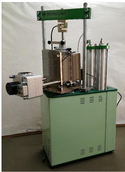
Рисунок 13 - Общий вид устройства для исследования образцов грунта ЛИГА модификации КЛ1С с применением срезовой/сдвиговой каретки с двумя волюмометрами
