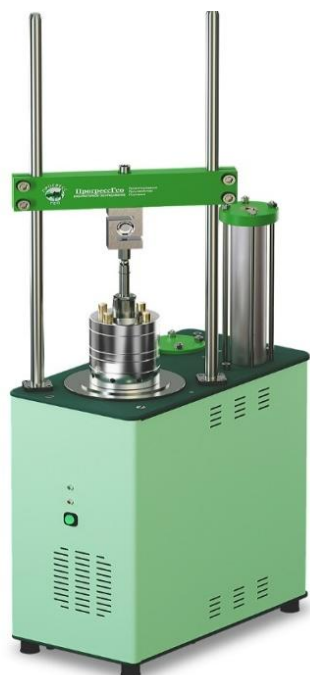
Рисунок 9 - Общий вид устройства для исследования образцов грунта ЛИГА модификации КЛ1С с применением компрессионного одометра с одним волюмометром
