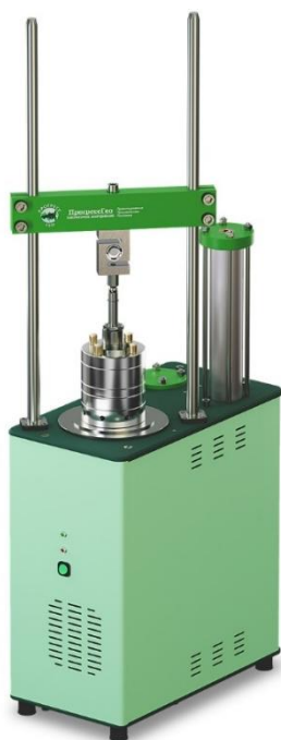
Рисунок 5 - Общий вид устройства для исследования образцов грунта ЛИГА модификации КЛ1 с применением компрессионного одометра с одним волюмометром
