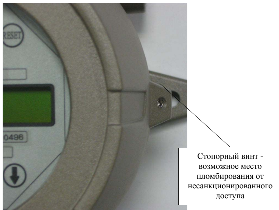
Рисунок 2 - Схема пломбирования газоанализаторов (на примере GIR-3000)
